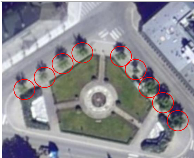
Figur 2: Eksempel på enkelttrær som skal registreres som InnmåltTre. Til høyre en illustrasjon som viser hvor enkelttrær skal registreres (midt tre og topp krone).
